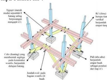
**Gambar 3.** Konstruksi Uma Jompa
