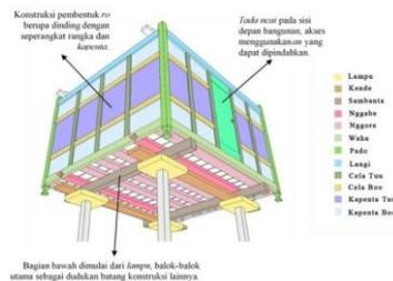
**Gambar 6.** Konstruksi Ro Uma Jompo
